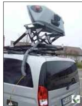
Die Erfassung erfolgte mit dem fahrzeuggestützten Messsystem Trimble MX8 .
