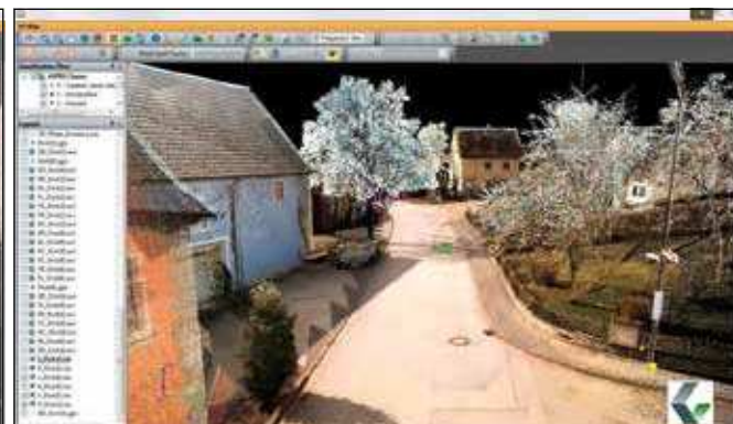
RGB-kolorierte Punktwolke mit digitalisierten 3D-Objekten – Perspektive.
